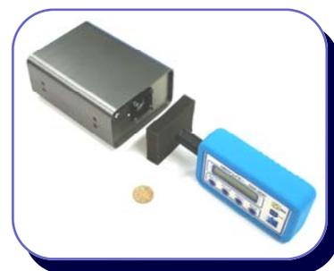
GMカウンタでX線の発生及びX線の透過率の実験例。
