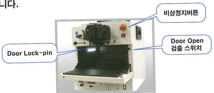
X선 전원이 켜진 상태에서는 도어가 열리지 않는 이중 안전 설계
